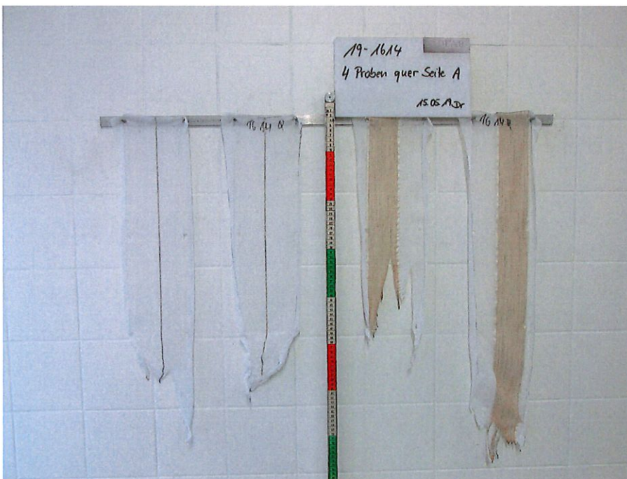
Bild 2: Aussehen der Proben nach dem Brandversuch
