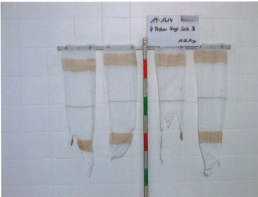
Bild 2: Aussehen der Proben nach dem Brandversuch
